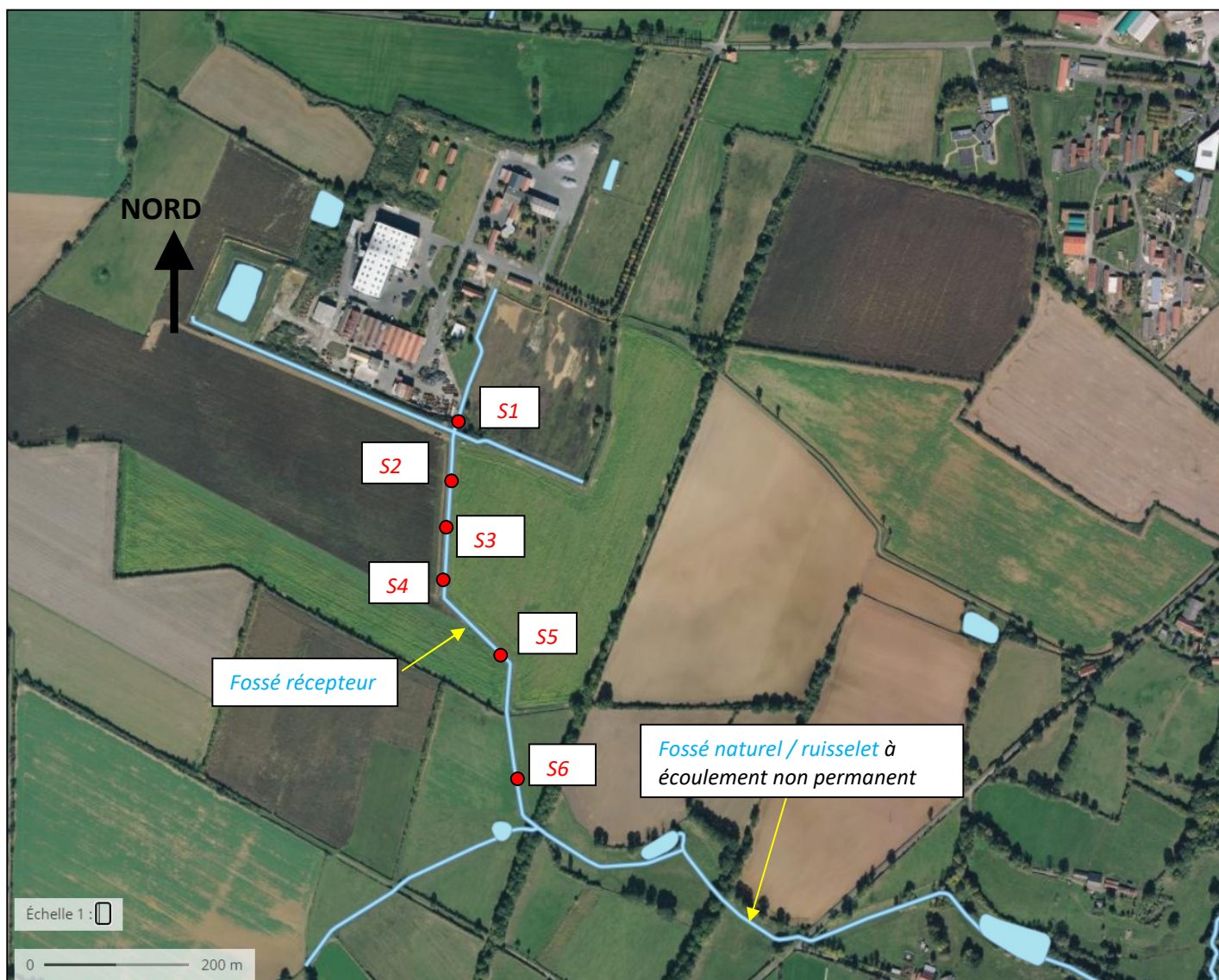
Localisation de sondages de sol réalisés dans le fossé
